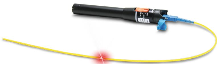
Wo Glasfasern verlegt, konfektioniert und genutzt werden, erleichtert der **FiberCheck2** die schnelle und sichere Fehlersuche: Das handliche Gerät koppelt über einen Ferrulenadapter rotes Laserlicht in ein Glasfaserkabel ein. Im Falle eines Bruches der Glasfaser tritt das Laserlicht aus der Faser aus und lässt den Fasermantel hellrot aufleuchten. Auch zu enge Biegeradien oder schlecht konfektionierte Steckverbinder lassen sich so lokalisieren.
