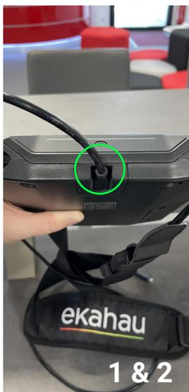
1. Laden Sie den Ekahau Sidekick auf, indem Sie ihn über das **Netzteil** mit einer Steckdose verbinden.
