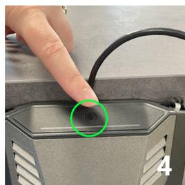
4. Starten Sie den Sidekick, indem Sie den **Ein/Aus-Schalter mindestens 2 Sekunden lang drücken**. Der LED-Balken leuchtet farbig von rechts nach links auf und der Sidekick startet. Wenn die LED-Leiste blau (noch nicht per Kabel verbunden) oder grün (bereits per Kabel verbunden) leuchtet, ist der Sidekick betriebsbereit.
